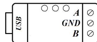
Рис 1. Обозначение выходов адаптера USB-485.
