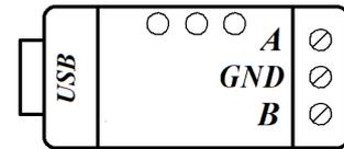
Рис 1. Обозначение выходов адаптера USB-485.
